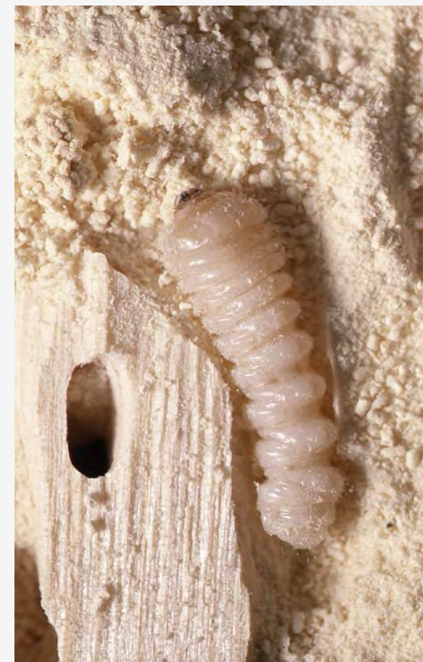
Schadbild Fraßgang und Ausflugloch
