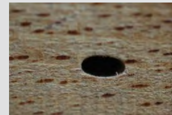
Ovale Fluglöcher mit 4-6 mm Längs-Ø
